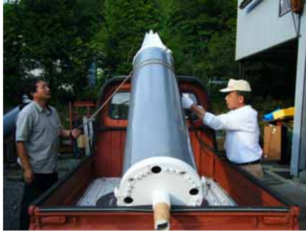
3号機製作 1mm鉄板を内軸に固定（久保田氏 石徹白）
